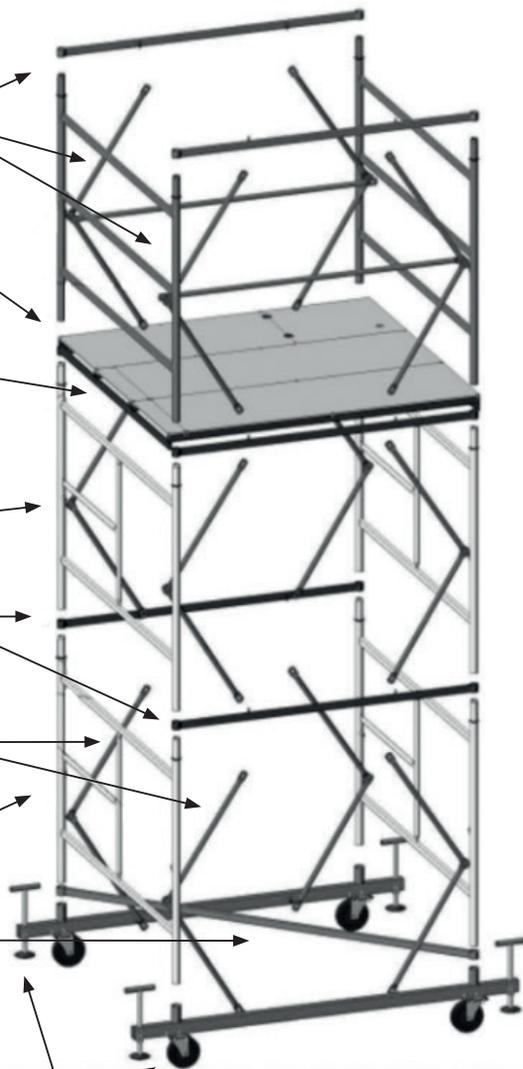
При сборке вышки высотой более 4 секций, у основания необходимо установить и закрепить стабилизаторы (не входят в комплект поставки) для дополнительной устойчивости.
