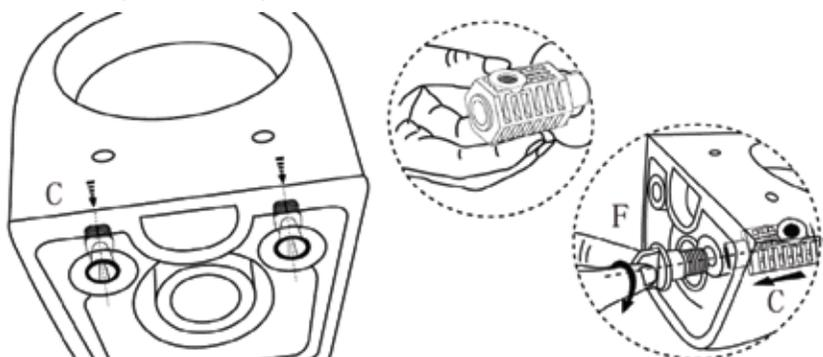
4. Установите чашу унитаза на шпильки, предварительно проложив между стеной и унитазом изолон (в комплект не входит).
