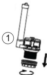
3. Вставьте седло в отверстие бачка и зафиксируйте с помощью прокладок и гаек. Не перетягивайте гайку! Максимально допустимый момент затяжки 14Н\*м.
