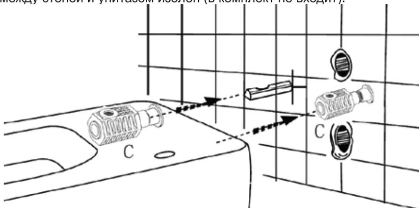
5. С помощью пластиковых трубок (E) и шестигранного ключа (A) вкрутите винты (D) в эксцентриковые вставки (C).
