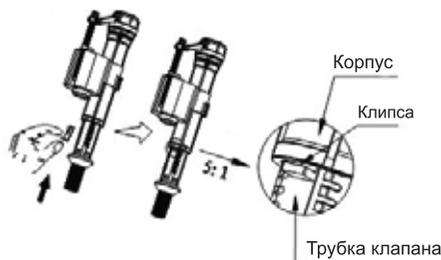
4. Для более точных установок уровня воды: сдвиньте фиксатор держателя поплавка в положение Open.
