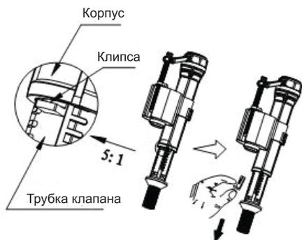
2. Поверните трубку клапана по часовой стрелке относительно корпуса. Отрегулируйте высоту клапана. Уровень воды соответствует верхнему краю поплавка. Он должен быть на 2-4 см выше трубки перелива.
