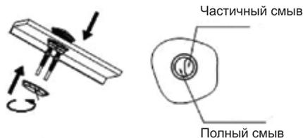
3. Отрегулируйте длину стержней кнопки, вращая их по часовой или против часовой стрелки таким образом, чтобы стержни касались нажимных пластин. Белая пластина отвечает за полный смыв и отмечена соответствующим значком (O).
