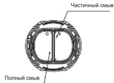
4. После настройки зафиксируйте кнопку прижимной гайкой.
