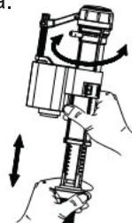
3. Поверните трубку клапана против часовой стрелки. Установите клипсу (фиксатор).
