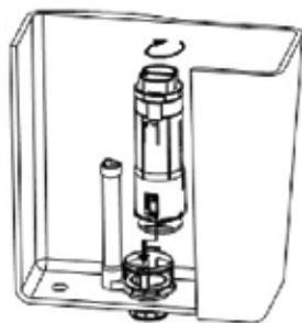
5. Установите резиновую прокладку на гайку снизу бачка.
