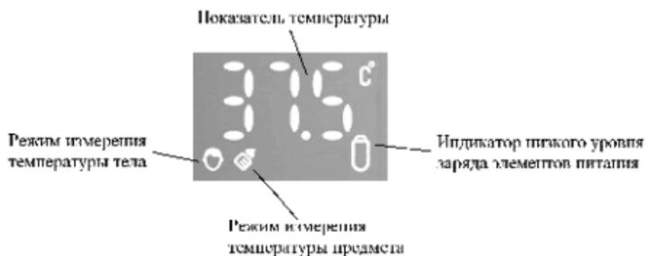
Рисунок 2 — Условные обозначения ЖК-экрана
