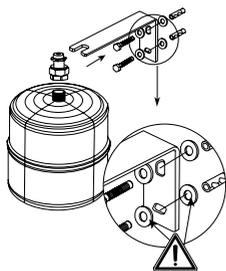
Консоль устанавливается в непосредственной близости от котла. Консоль подключается к подающему трубопроводу системы отопления трубой с проходным сечением не менее 15 мм; труба должна быть как можно короче, и на ней не должно быть никакой запорной арматуры.
