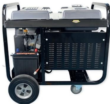
Присоедините колеса в предусмотренные места на раме генераторной установки при помощи входящих в комплект крепежных элементов.
