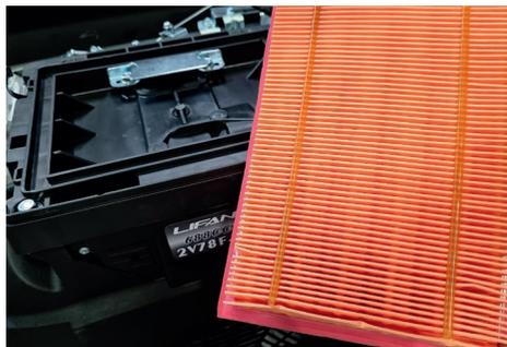
1. Откройте крышку воздушного фильтра и проверьте его наличие и степень загрязнения.
