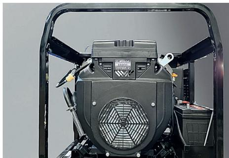
1. При подключении сначала присоедините провод красного цвета к плюсовому выводу (+) аккумуляторной батареи, а после этого присоедините кабель черного цвета к минусовому выводу (-) аккумуляторной батареи.
