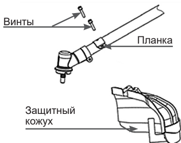
Рис. 3 Установка защитного кожуха
