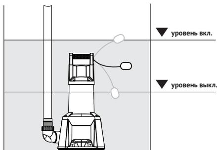
Рисунок 5 – Поплавковый выключатель
