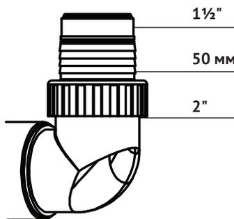
Рисунок 3 - Соединение с напорным патрубком
