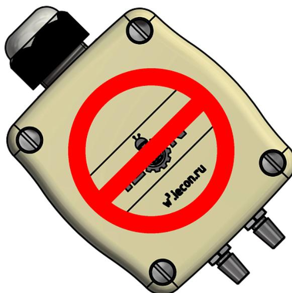
Если кабельный ввод датчика будет направлен вверх, то вода которая может попасть на датчик может попасть в корпус и вывести датчик из строя.
