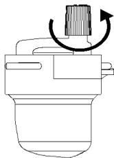
2. Вращение против часовой стрелки крана подпитки воды осуществляет поступление теплоносителя в систему отопления
