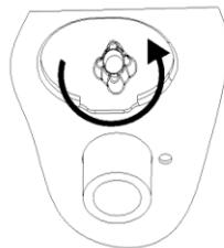
3. Обратите внимание на дисплей, когда давление достигнет 1Bar-1.5Bar, закройте кран подпитки системы отопления.
