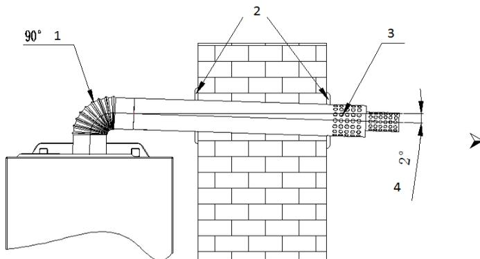
1- 90° патрубок; 2-уплотнение трубы дымоотвода; 3- труба дымоотвода; 4-уклон 2°
