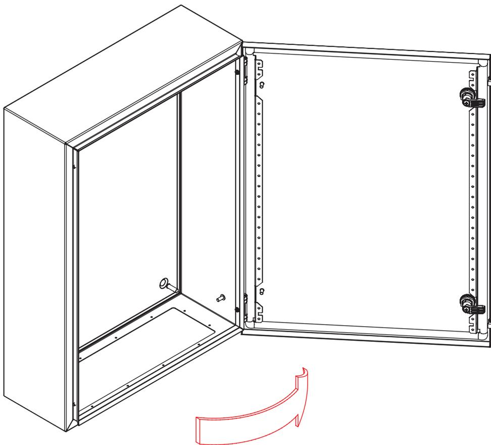
Снятие двери для перенавески на противоположную сторону корпуса
