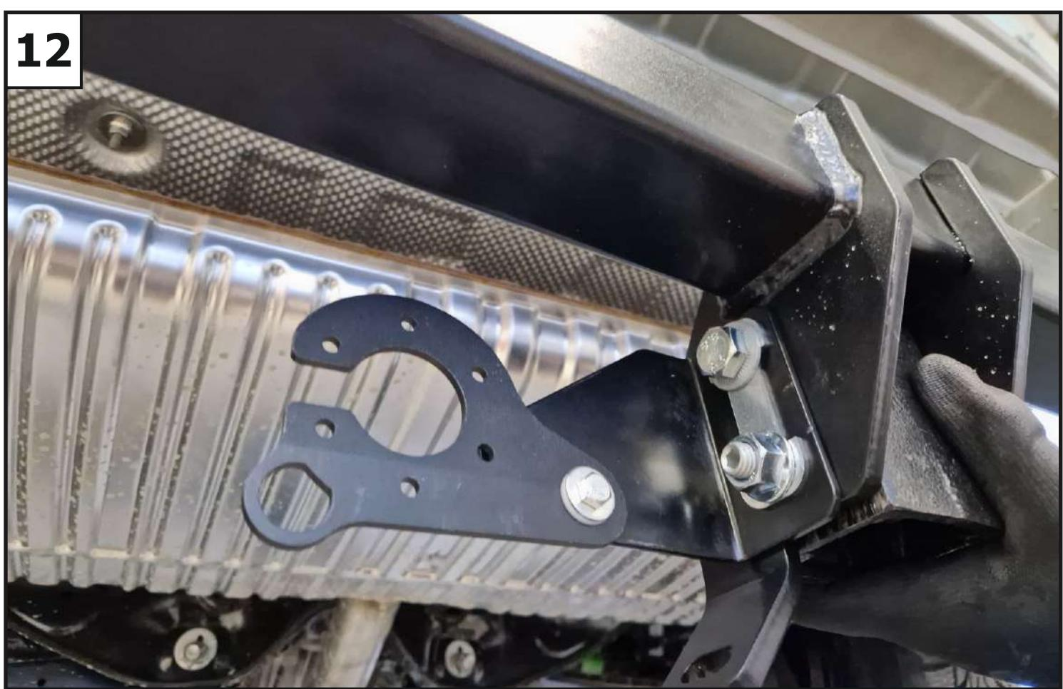
Установить кронштейн под розетку (3), закрепив с помощью болта M6x25 (11), шайб 6 увеличенных (23), шайб 6 полиамидных (24) и гайки M6 (19). Затянуть все резьбовые соединения. Моменты затяжки: M6=6 Нм; M12=81 Нм.
