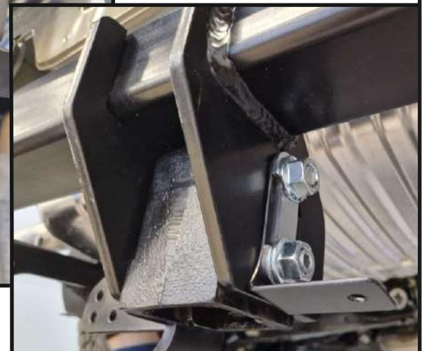
Установить ответную часть быстросъема, пластины (9), кронштейн (2) и кронштейн бампера (6), закрепив с помощью болта M12x100 (18), шпильки M12x25 (14), шпильки M12x35 (15), шайбы 12 с насечками (30) и гаек M12 с фланцем (21). Шпильки (14 и 15) закручивать до упора без усилия.
