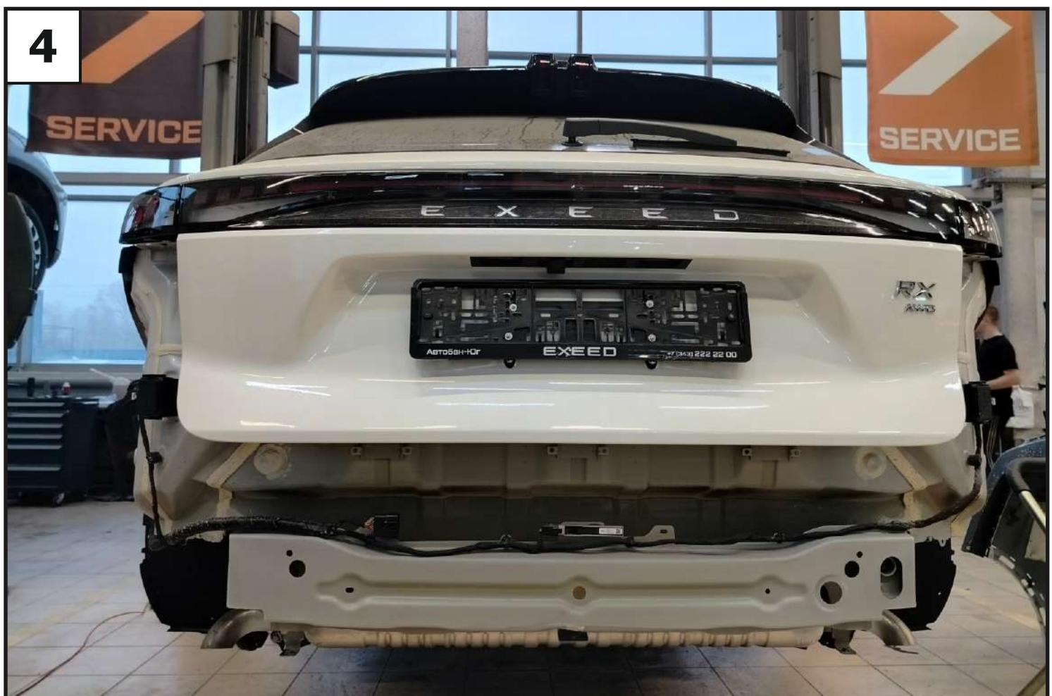
Демонтировать задние фонари, после демонтировать задний бампер, отключив разъем электропроводки.
