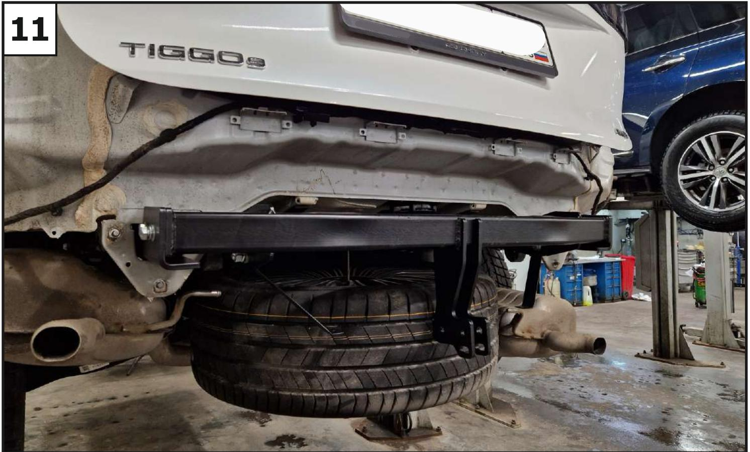
Перед установкой балки (1) необходимо прогнать ее резьбовые отверстия при помощи метчика M12x1,25. Установить балку (1), кронштейн бампера левый (9) и кронштейн бампера правый (10), закрепив с помощью болтов M12x1,25x40 (17), шайб 12 (28), шайб 12 пружинных (29) и гаек M12x1,25 (21).
