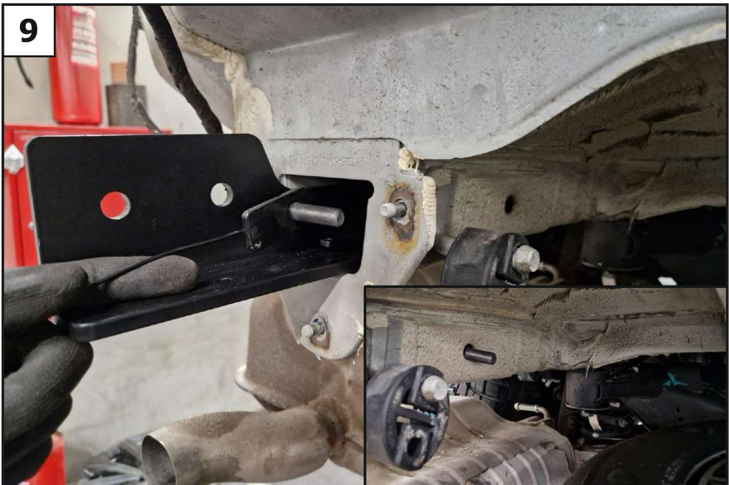
Установить закладную M12x1,25 (13) в лонжерон через отверстие в задней панели.
