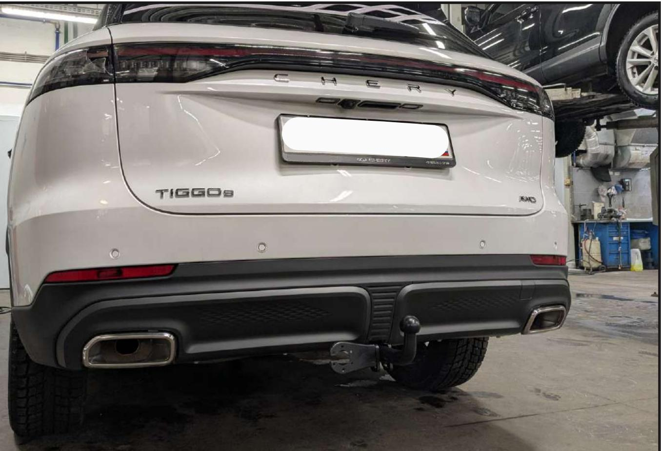
**Установить крюк (6) и кронштейн под розетку (7) на балку (1) с помощью болтов M12x1,25x70 (18), шайб 12 (28), шайб 12 пружинных (29) и гаек M12x1,25 (21). Затянуть все резьбовые соединения. Момент затяжки: M12=81 Нм.**
