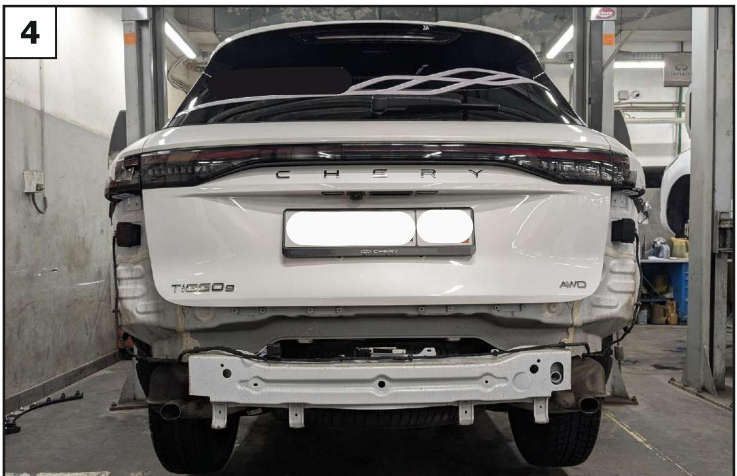
Демонтировать задние фонари, после демонтировать задний бампер, отключив разъемы проводки.
