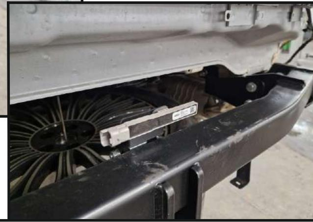
Установить кронштейн антенны (11), закрепив при помощи болта M6x60 (15), шайб 6 (23), шайбы 6 пружинной (22) и гайки M6 (19), после установить антенну.
