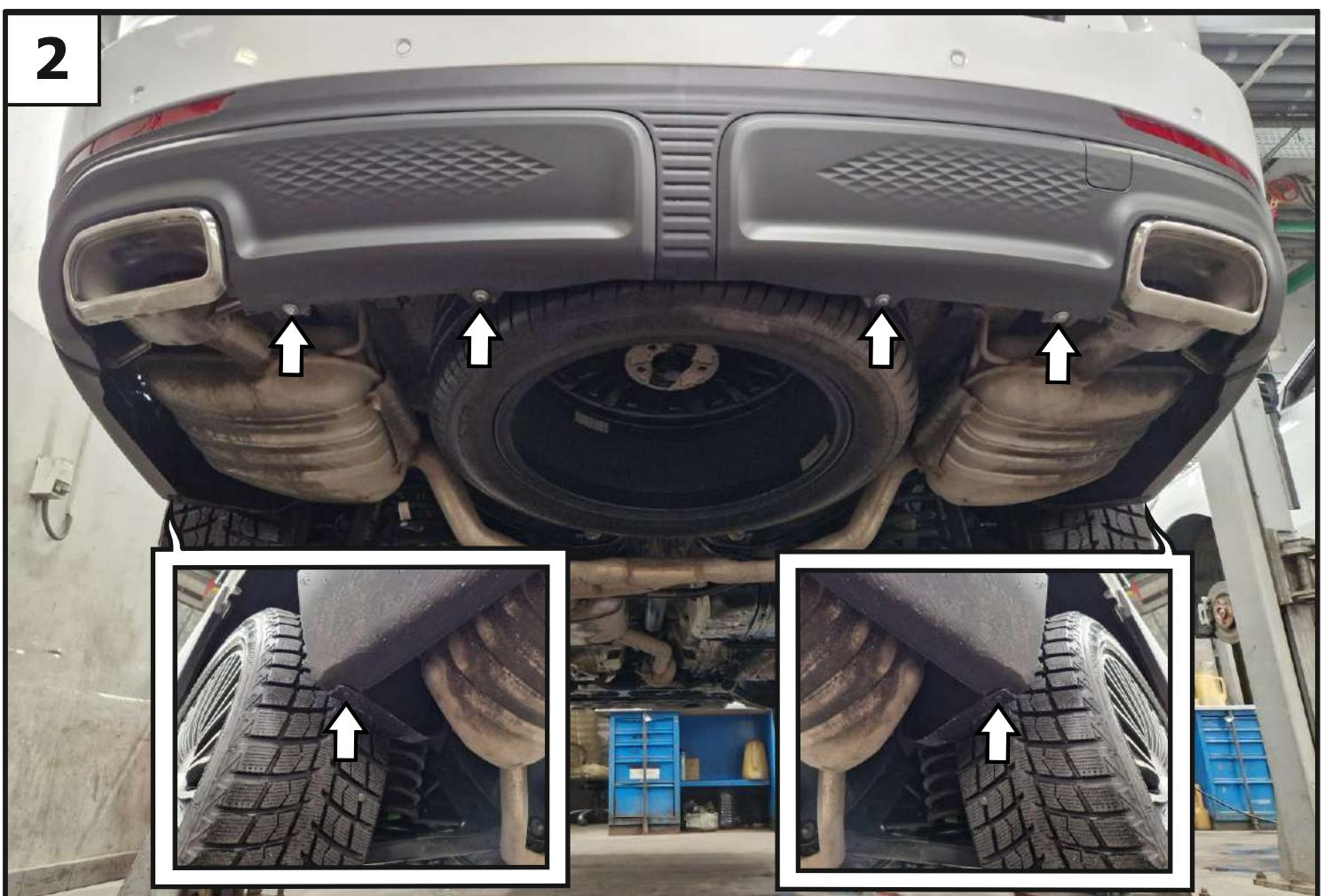
Выкрутить болты и винты крепления заднего бампера.
