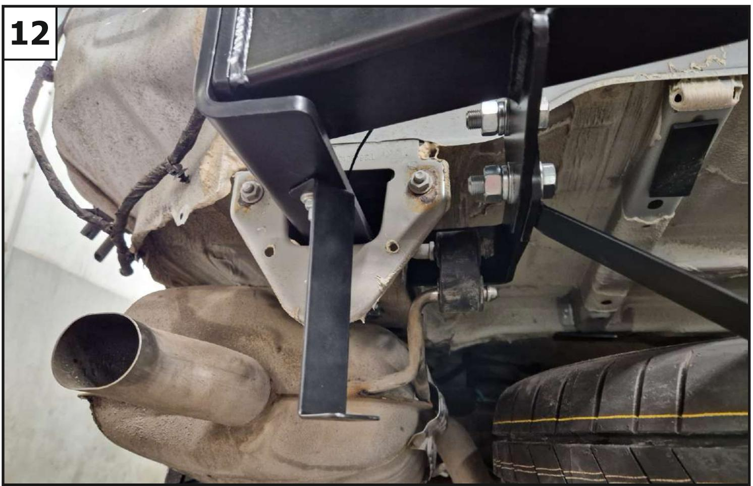
Установить кронштейн крепления бампера (8) на кронштейн левый (3) при помощи болта M6x25 (14), шайбы 6 (23), шайбы 6 увел. (24), шайбы 6 пружинной (22) и гайки M6 (19). С другой стороны аналогично.
