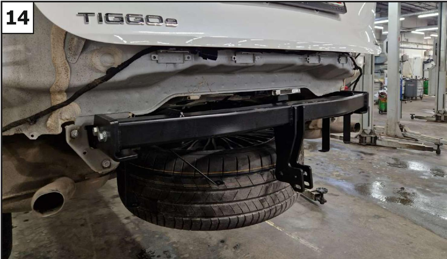
Отрегулировать положение ТСУ относительно центра автомобиля и затянуть все резьбовые соединения — сначала балку с кронштейнами и усиливающими кронштейнами, затем усиливающие кронштейны к лонжеронам автомобиля, после кронштейны с лонжеронами автомобиля. Моменты затяжки: M6=10 Нм; M10=47 Нм; M12=81 Нм.
