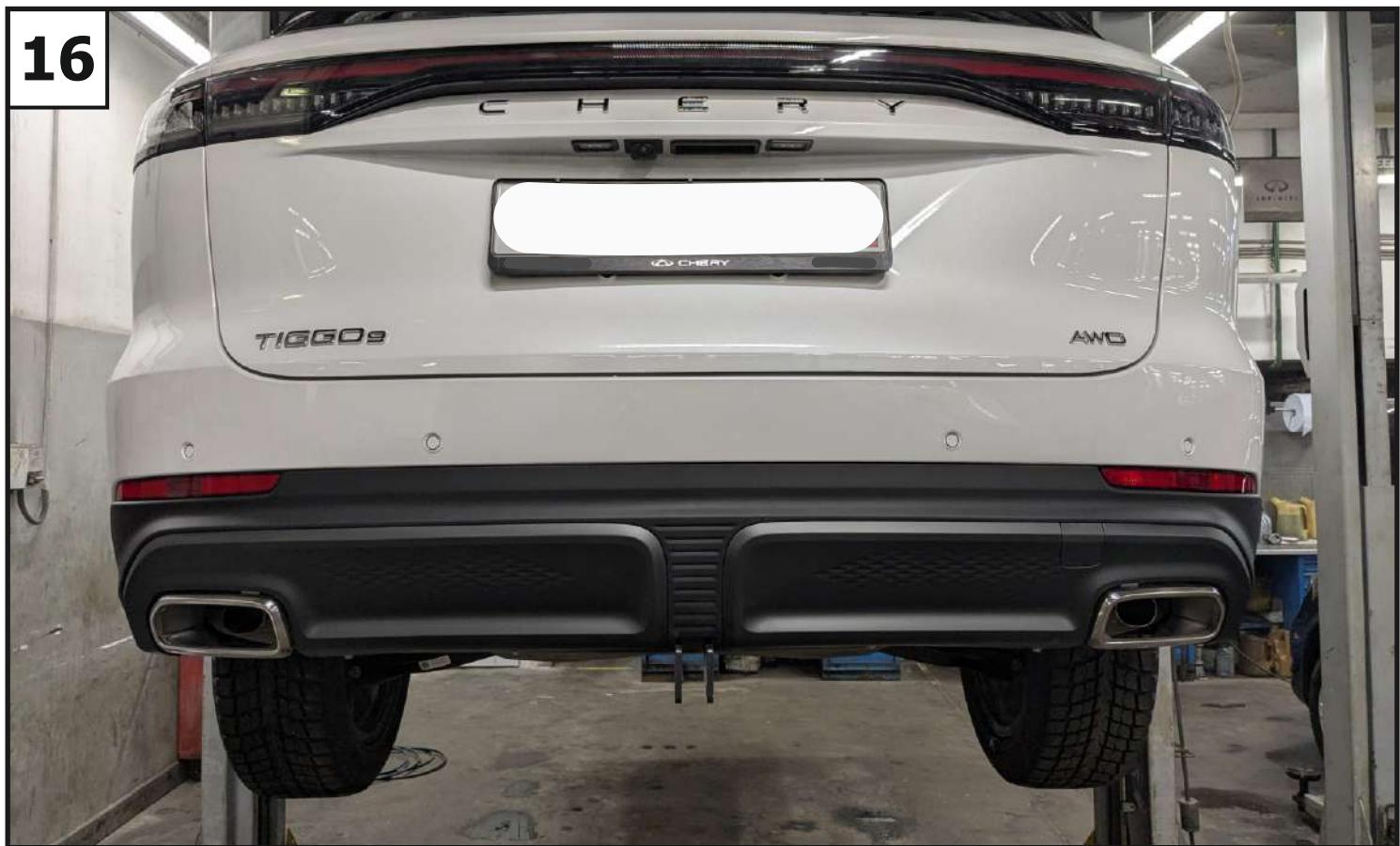
**Установить бампер и запасное колесо в обратной последовательности, и
