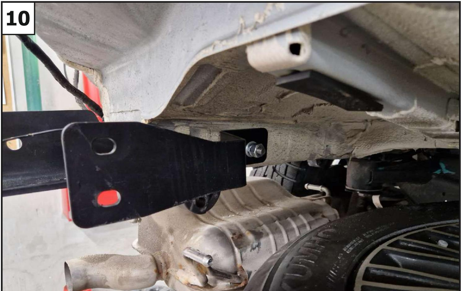
Установить кронштейн усиливающий левый (5), закрепив при помощи гайки M12x1,25 (21), шайбы 12 (28), шайбы 12 пружинной (29). С другой стороны аналогично.
