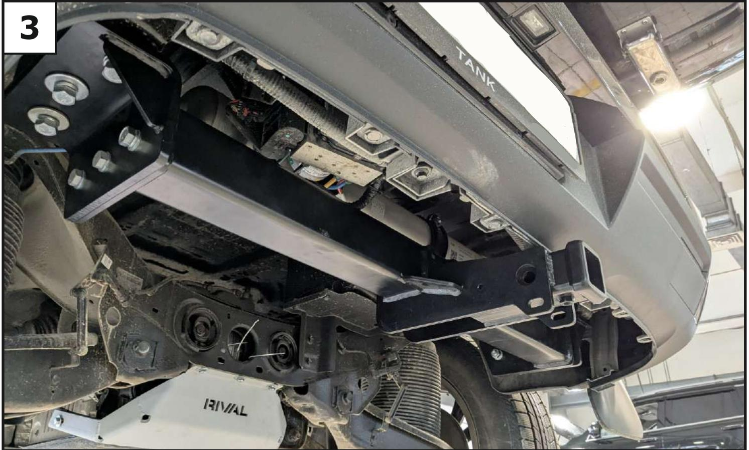
Перед установкой балки (1) необходимо прогнать ее резьбовые отверстия при помощи метчика M12x1,25. Установить балку (1) закрепив её к кронштейнам (2, 3) при помощи болтов M12x1,25x40 (11), шайб 12 (18), шайб 12 пружинных (19) и гаек M12x1,25 (14).
