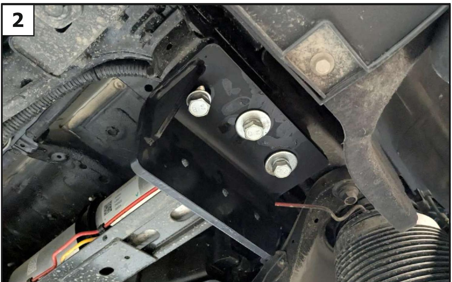
Установить кронштейн правый (3), закрепив его к штатным закладным при помощи болтов M14x1,5x40 (12), шайбы 14 (20), шайб 14 увелич. (22) и шайб 14 пружинных (21). С другой стороны аналогично.
