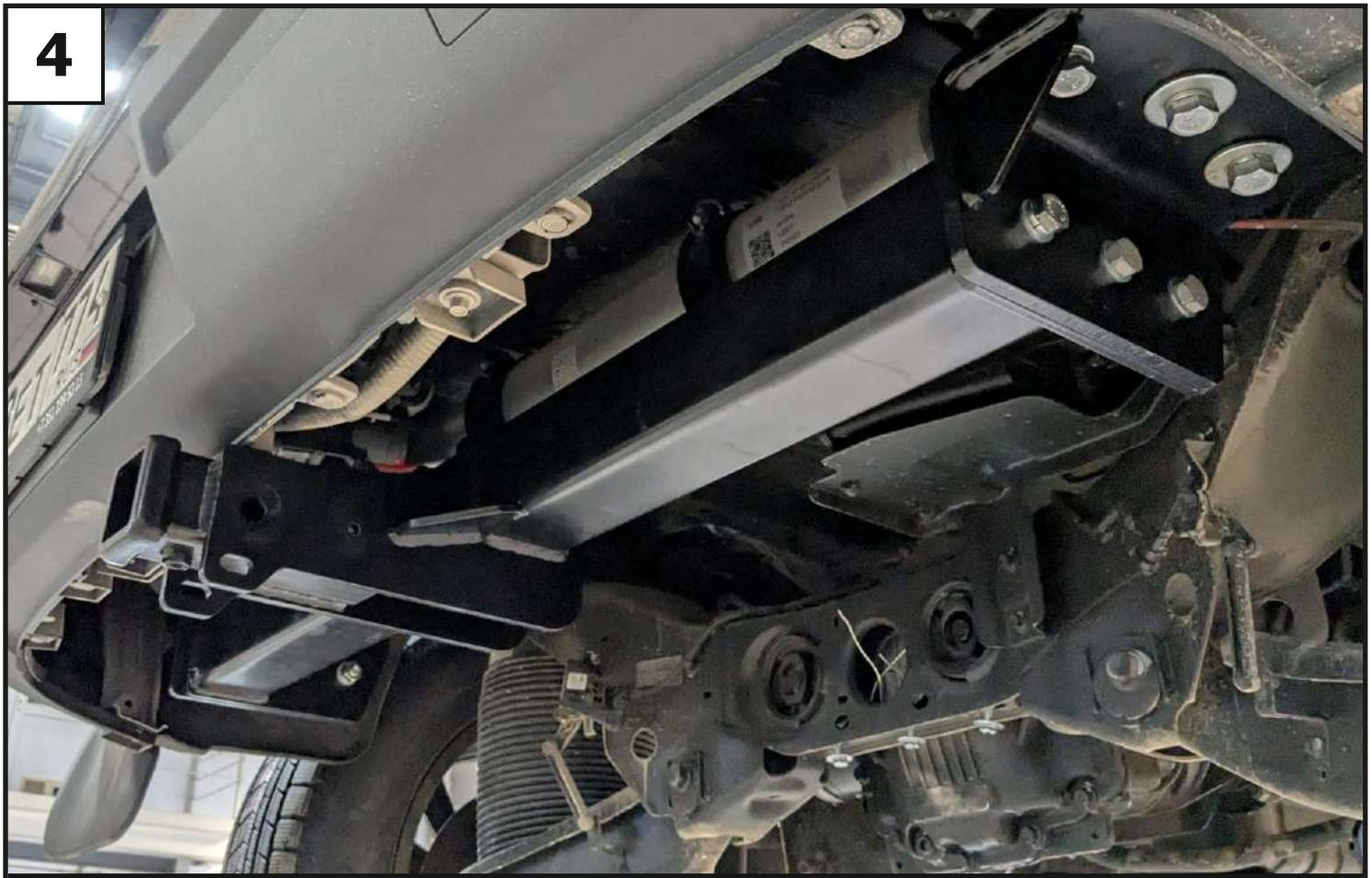
Отрегулировать положение ТСУ относительно центра автомобиля и затянуть все резьбовые соединения — сначала балку с кронштейнами, затем кронштейны с лонжеронами автомобиля. Моменты затяжки: M12=81 Нм, M14=126 Нм.
