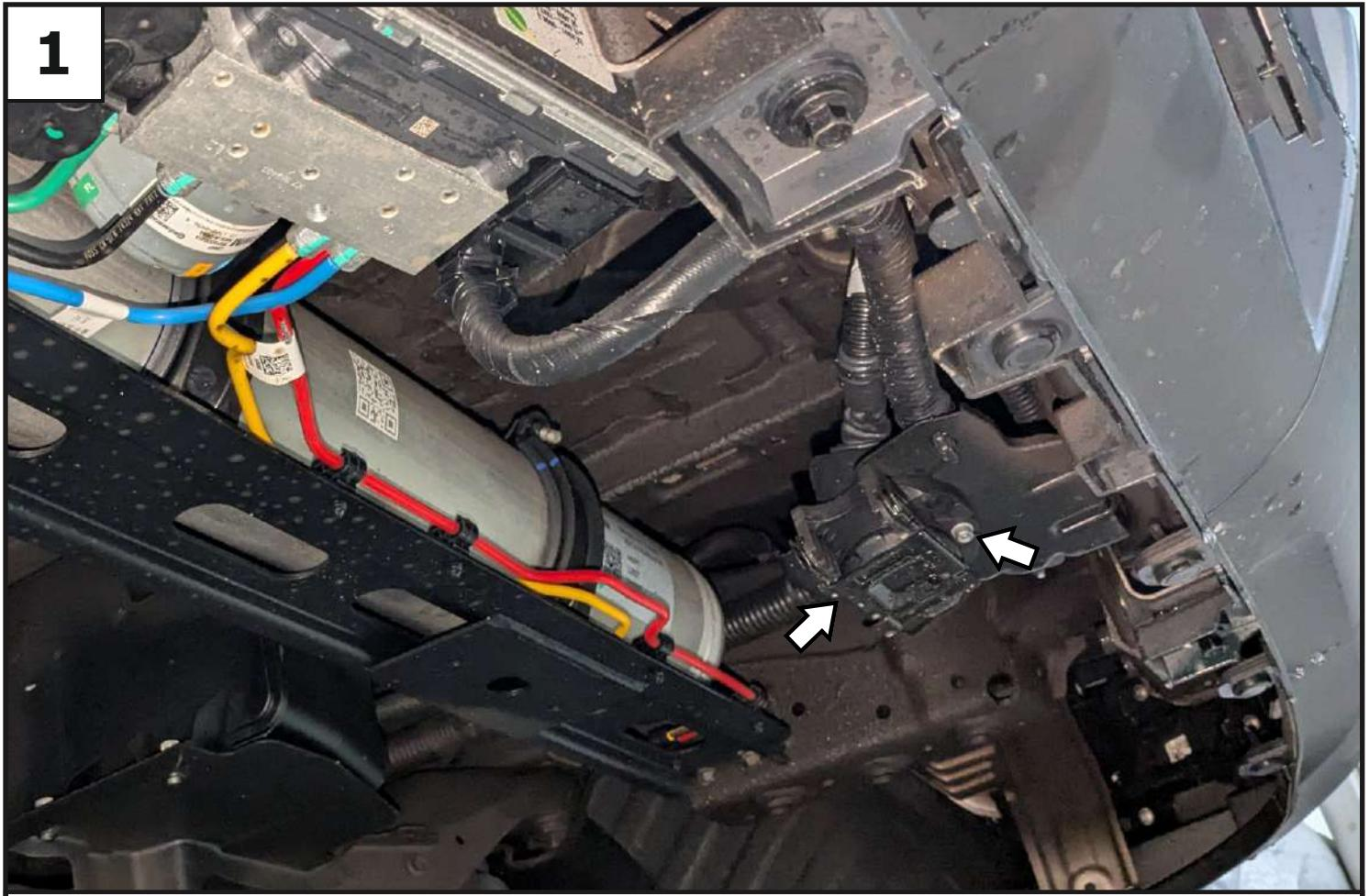
Открутить болты крепления розетки и снять её с кронштейна. В дальнейшем установить розетку на кронштейн под розетку (4).
