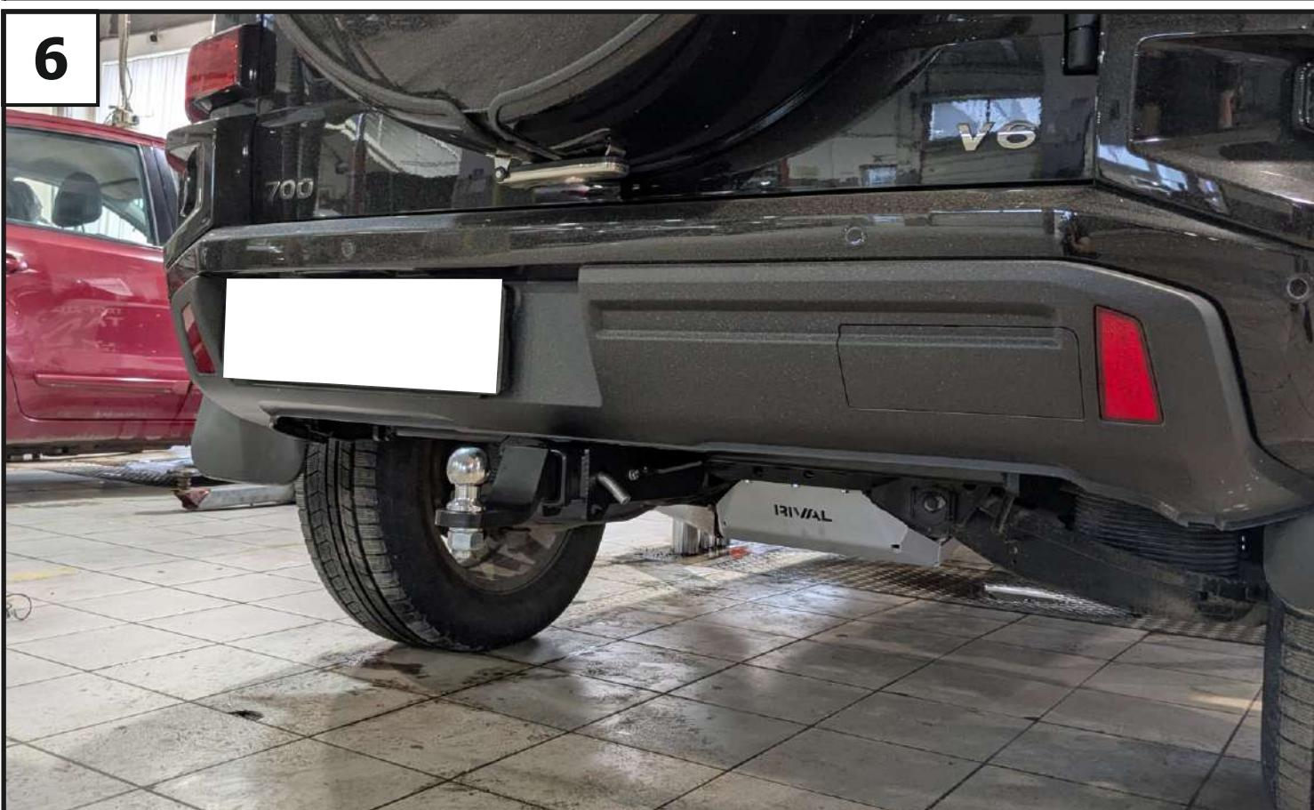
Установить переходник (5), закрепив с помощью штифта (7) и шплинта (8). Зафиксировать переходник болтом M10x20 (10) - фиксацию использовать только без нагрузки. Установить на переходник шар (6), закрепив гайкой M24 (23) с шайбой 24 пружинной (24). Затянуть все резьбовые соединения. Моменты затяжки: M8=25 Нм, M24=95 Нм.
