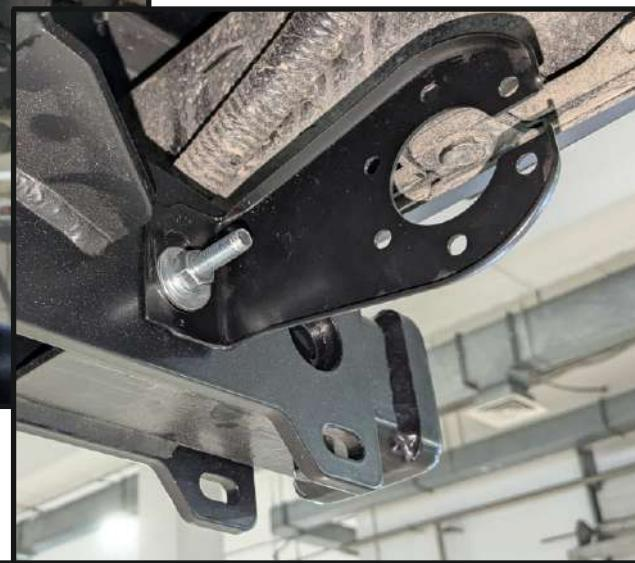
Установить кронштейн под розетку (4) на балку (1) с помощью болта M8x90 (9), шайбы 8 (15), шайбы 8 пружинной (16), шайбы 8 увел. (17) и гайки M8 (13).
