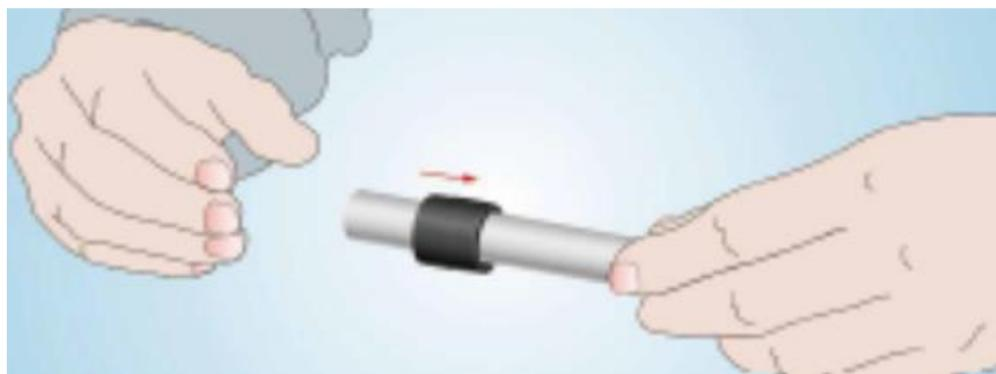
3. Вставьте конец трубы на соответствующую насадку расширителя
