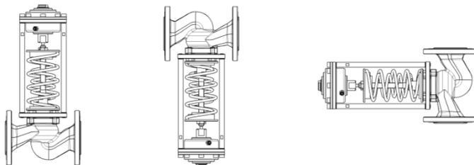
5. При более высокой температуре регулятор следует устанавливать только на горизонтальном трубопроводе регулирующим блоком вниз. Перед регулятором рекомендуется установить фильтр.
