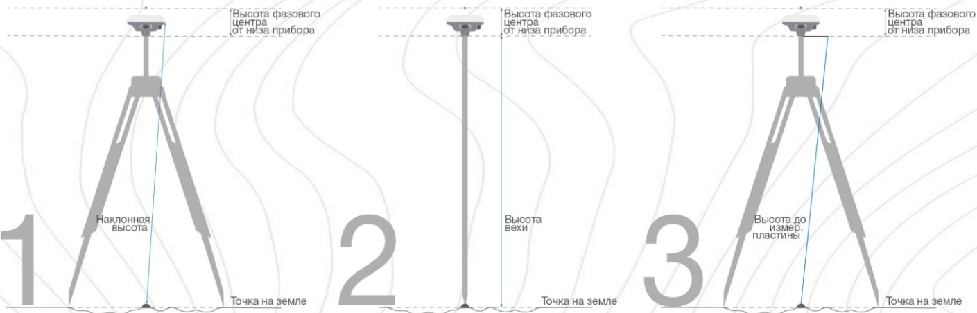
*Эти методы используются для определения истинной высоты фазового центра, что позволяет программному обеспечению рассчитывать правильное значение отметки при съемке точек.*
