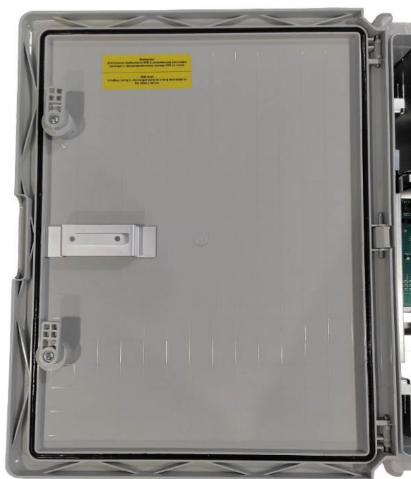
Рисунок 3.7.1 - Датчик вскрытия на крышке коммутатора
