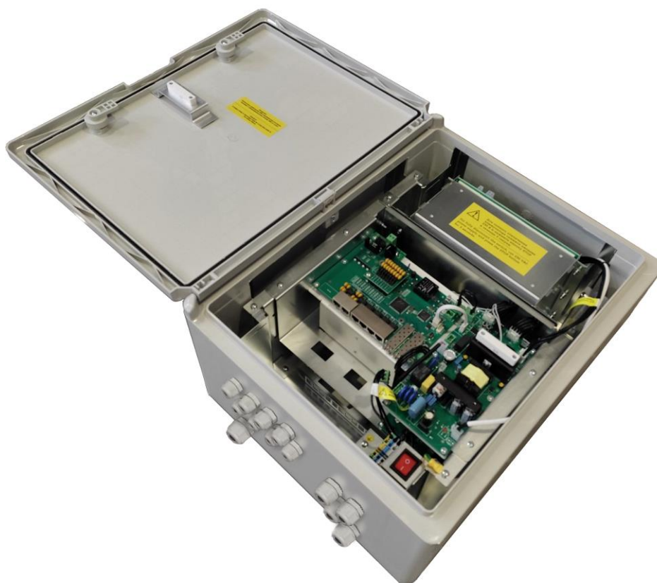
Рисунок 3.1.2 - PSW-2G6F+UPS-Box - вид внутри
