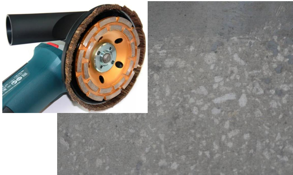
Шлифование поверхности бетонного основания алмазным инструментом
