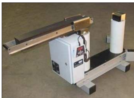
Рисунок 3: TH L с открытым затвором сердечника
