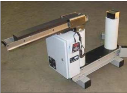
Bild 3: TIH L mit geöffnetem Joch
