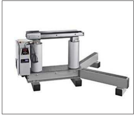
Bild 2: TIH L mit montierten Auflageschenkeln
