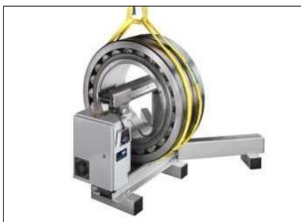
Figura 4: TIH L com aquecimento de peças vertical
