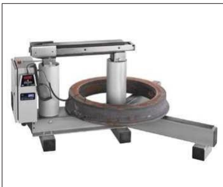
Рисунок 5: TH L с горизонтальным нагревом детали
