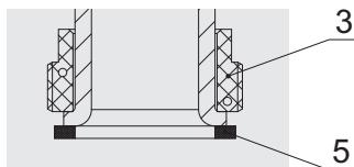
Тип «В» — сухарь с наружной резьбой 1½" (3) с плоским уплотнительным кольцом (5), используется для присоединения гидрострелки PROFACTOR® PF PU 1054.
