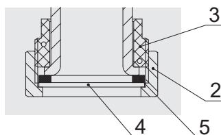
Тип «С» — глухой патрубок: заглушка формируется из накидной гайки (2) и глухой шайбы (4) и навинчивается на сухарь (3) с уплотнительным кольцом (5).
