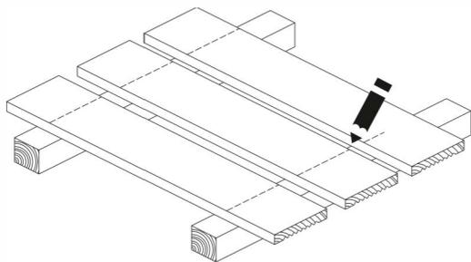
Произвести разметку на тыльной стороне доски в местах предполагаемого соединения доски с лагами (провести поперечные линии на доске вдоль центра плоскости соприкосновения с лагами).
