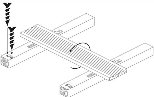
Перевернуть доску лицевой стороной вверх. Установить на лаги стартовые фиксаторы в соответствии с выступающими концами крепежей первой доски и закрепить с помощью двух саморезов.
