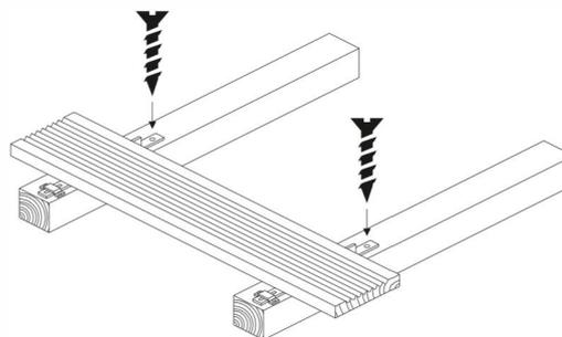
Завести выступающие концы крепежей Змейка® первой доски в пазы фиксаторов. Закрепить крепежи Змейка® на лаге через отверстие на «голове» крепежа с помощью самореза.
