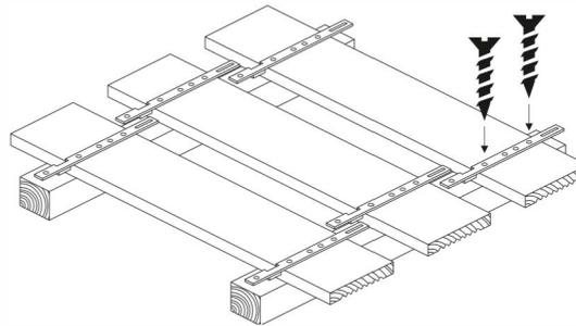
Разместить крепежи Змейка® на тыльной стороне доски в соответствии с разметкой (справа и слева от разметки на доске поочередно) и закрепить с помощью двух саморезов. Вынос «головы» крепежа за пределы доски определяется стопором (при наличии).
