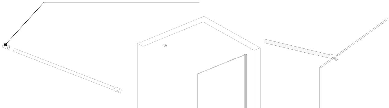
4. Пройдите силиконовым герметиком низ стекла, а также внутреннюю и внешнюю части пристенного профиля. При помощи очистителя для стекол, удалите излишки силиконового герметика, пока он не застыл. Не рекомендуется использование перегородки в течении 24 часов, после нанесения герметика.
