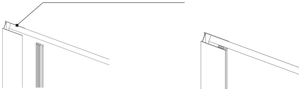
3. Соберите штангу, приложите на стекло и при помощи строительного уровня, обройсуйте на стене элемент крепления штанги. Снимите штангу, сделайте отверстие, уберите мусор. Закрепите элемент крепления штанги. Соберите штангу и затяните все шестигранные винты.
