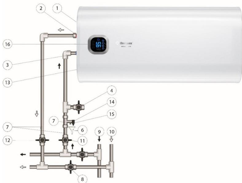
**Рисунок 1-2:** 1 – ЭВН, 2 – патрубок горячей воды, 3 – патрубок холодной воды, 4 – сливной вентиль, 5 – предохранительный клапан, 6 – дренаж в канализацию, 7 – подводка, 8 – перекрыть вентиль при эксплуатации ЭВН, 9 – магистраль холодной воды, 10 – магистраль горячей воды, 11 – запорный вентиль холодной воды, 12 – запорный вентиль горячей воды, 13 – защитная крышка, 14 – выпускная труба предохранительного клапана, 15 – ручка для открывания предохранительного клапана, 16 – панель управления.
