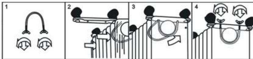
**ВНИМАНИЕ:** Ни в коем случае не пользуйтесь прибором, если колеса не установлены или установлены неправильно! После закрепления колес, переверните радиатор и поставьте его на пол, колесами вниз.
