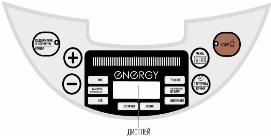
1. ДИСПЛЕЙ - на дисплее отображается время приготовления, температура.
