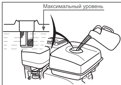
Рис. 25. Максимальный уровень топлива в топливном баке
