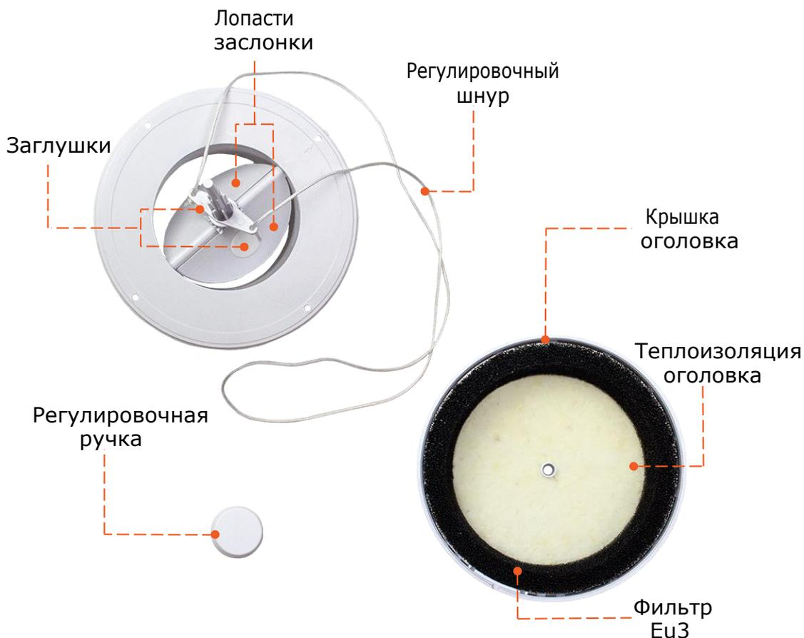
Патрубок (фланец) клапана с силиконовым уплотнителем плотно вводится в трубу и фиксируется к стене с помощью 4-х шурупов. Узел регулировки позволяет регулировать степень открытия/ закрытия заслонки при помощи утопленного колесика на корпусе или шнура. Фильтр класса EU3 (G3) изготовлен из пористого моющего синтетического материала, эффективно задерживающего пыль и шум. На фасадную сторону крышки оголовка клапана нанесена фактурная шкала, показывающая степень открытия заслонки
