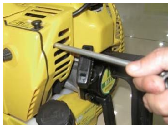
Винт регулировки оборотов холостого хода (доступ через жалюзи капота)
