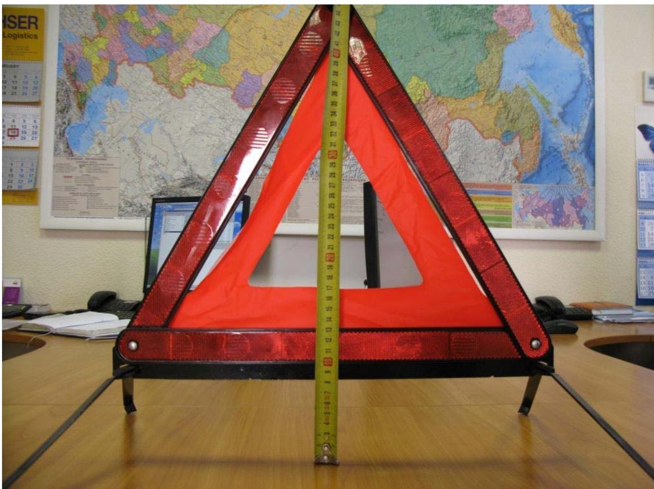
*Расстояние между опорной поверхностью и нижней стороной предупреждающего треугольника 80 мм., что в пределах нормы - не более 300 мм.*
