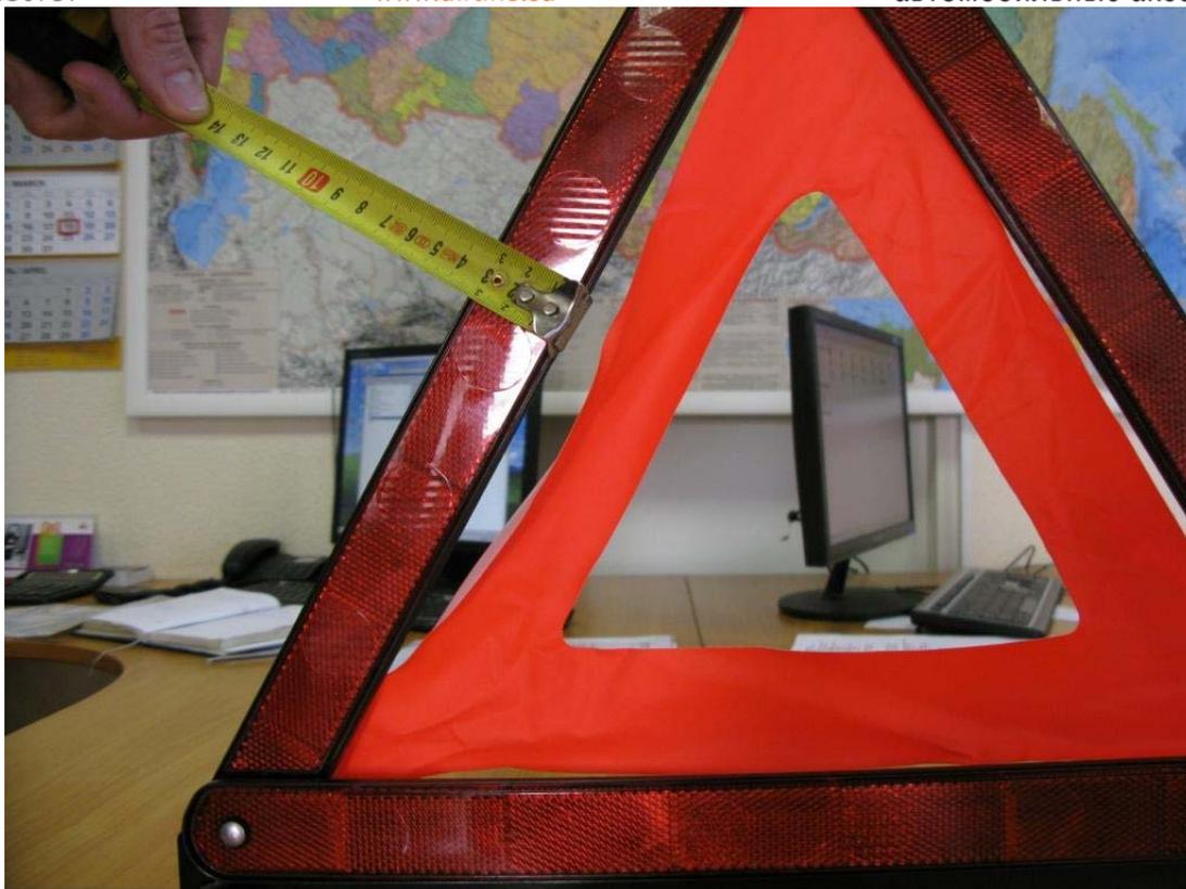
*Светоотражающий элемент (левый) располагается по краю в пределах полосы, одинаковой шириной 34 мм, что в пределах нормы - 25 – 50 мм.*
