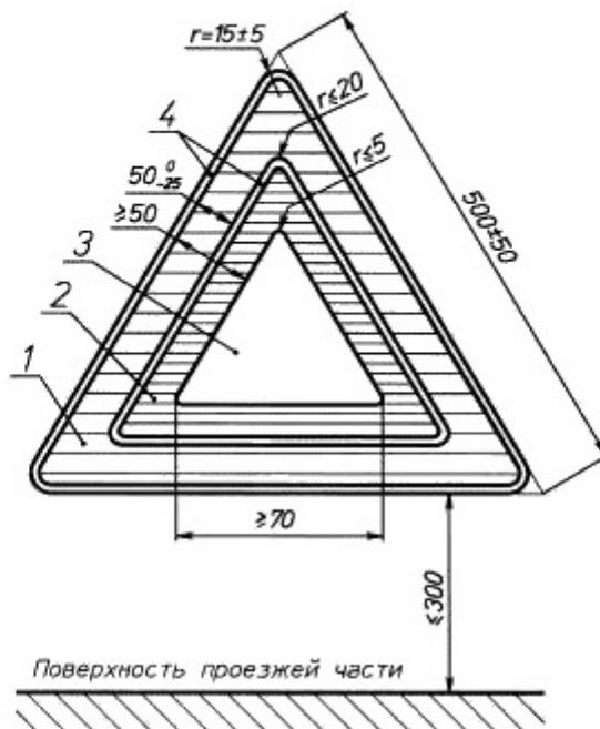
1 — красная светоотражающая часть; 2 — красная флуоресцирующая часть. Общая площадь не менее 315 см<sup>2</sup>; 3 — поляя часть; 4 — кромка необязательно красного цвета шириной не более 5 мм
