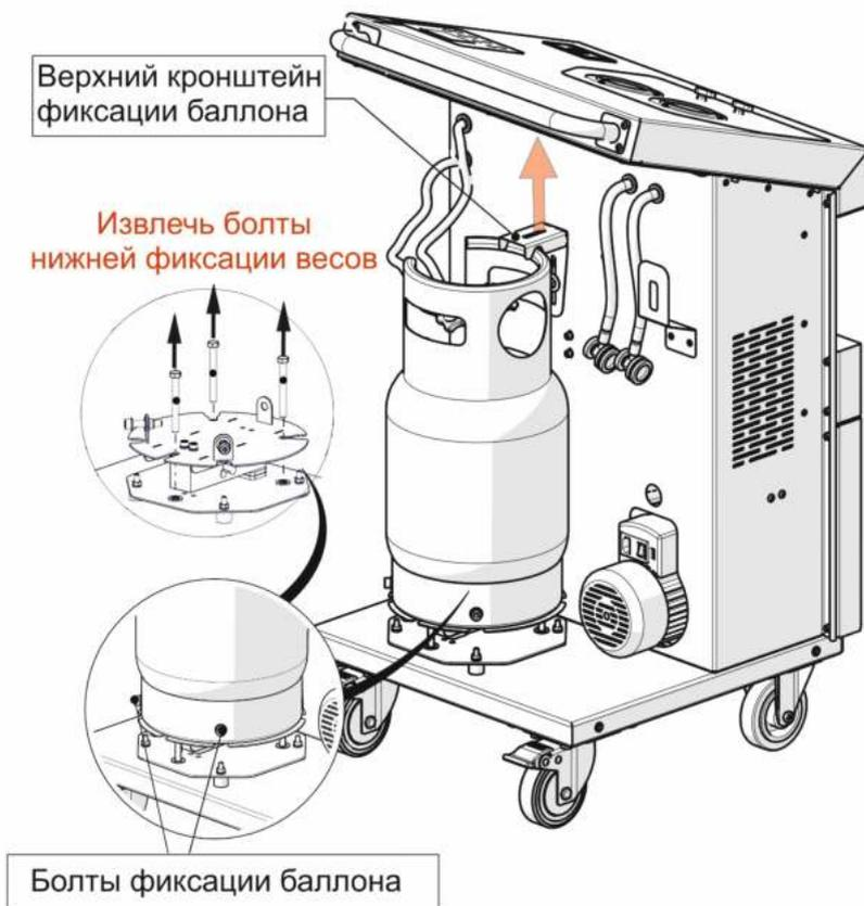
Рис. 5 Фиксация внутреннего баллона
