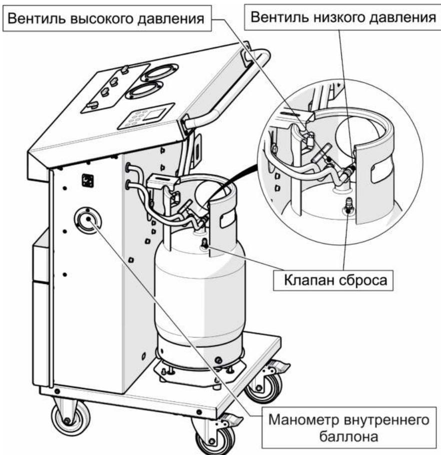
Рис. 7 Сброс неконденсируемых газов.
