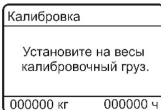
12.3.3.5. После звукового сигнала калибровка завершена.
