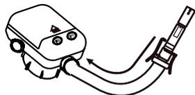
6. Установите выходной штуцер в сливное отверстие устройства и зафиксируйте его при помощи зажима.
