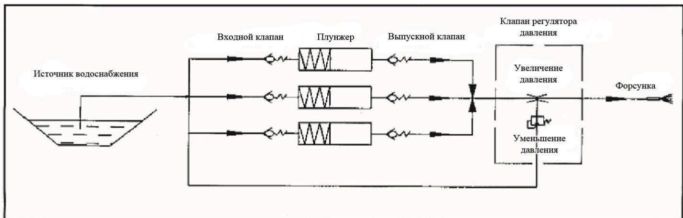
При включении в сеть вал помпы приводится в движение двигателем. Движение от вала передается плунжеру насоса, который совершает возвратно-поступательные движения. Когда объем камеры помпы увеличивается, входной клапан открывается, а выпускной закрывается, и вода поступает в камеру помпы по шлангу через входной клапан. Когда объем камеры помпы
