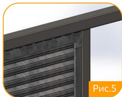
5. Установить следующий спаренный отлив 42x2490 мм (приложить усилие для его распорки по посадочному месту) через верх стоек. Таким же способом осуществить сборку конструкции. Загнуть по линии перфорации паранет для наполнения 80x2010 мм. (Рис.5)
