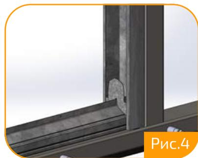
4. Подготовить вставки. Осуществить сгибы под прямым углом по линии перфорации. Установить внутри стоек поверх спаренных отливов с двух сторон. (Рис.4)
