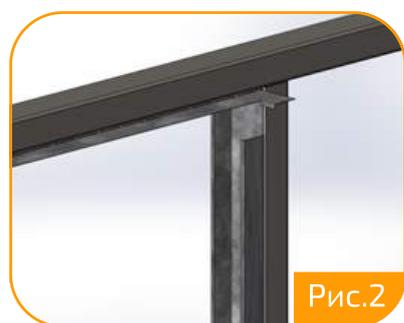
2. Паранет для наполнения 80x2010 мм установить над стойками, зафиксировать саморезами к верхнему профилю проема. (Рис.2)
