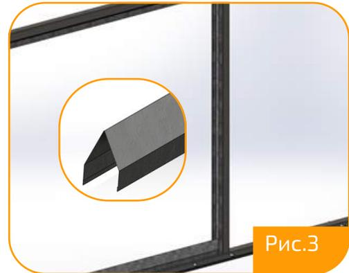
1. Планку закрывающую 63x40x2010 мм распределить равномерно и прикрепить на 3 самореза к профилю (60x60 мм) верхней части проема. (Рис.1)
