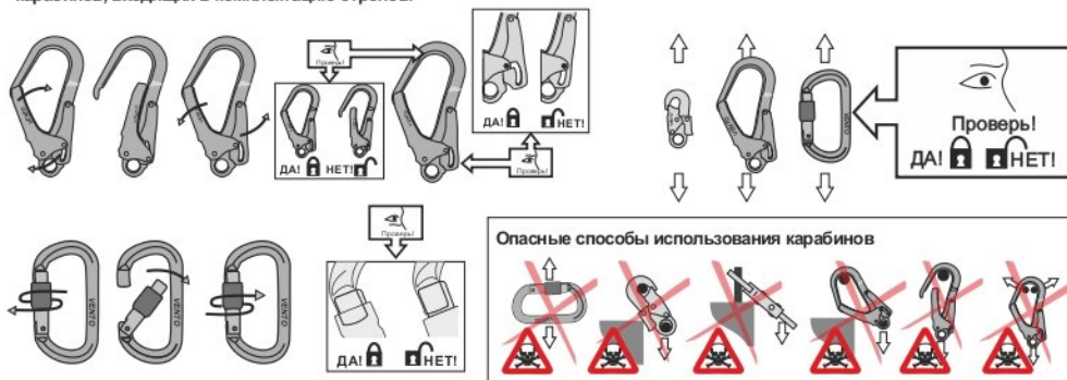
Рис. 6. Способы крепления стропов к анкерным устройствам
