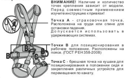
Рис. 3. Расположение и назначение крепежных точек на привязях
