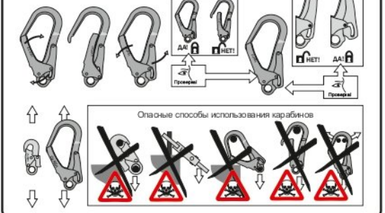
Рис. 8. Ограничения по использованию стропов с амортизатором
