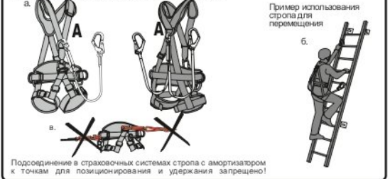
Рис. 6. Использование карабинов, входящих в состав стропов
