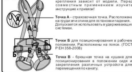
Рис. 5. Способы крепления к анкерным устройствам
