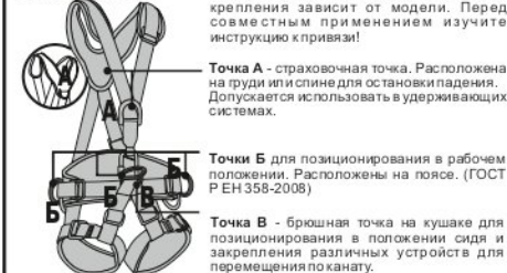
Рис. 5. Способы крепления к анкерным устройствам
