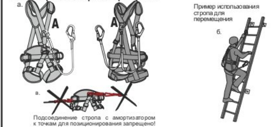
Рис. 5. В страховочных системах допускается использование только стропов с амортизатором рывка
