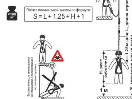
Рис. 9. Способы крепления к анкерным устройствам
