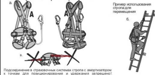
Рис. 6. Использование карабинов, входящих в состав стропов
