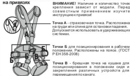
Рис. 5. Способы крепления к анкерным устройствам
