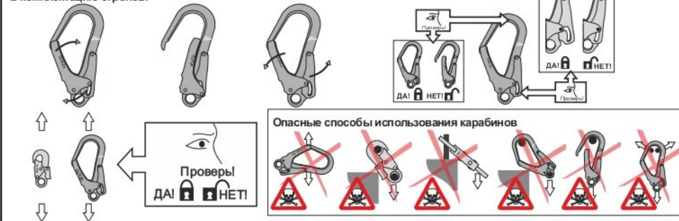
Рис. 6. Способы крепления стропов к анкерным устройствам
