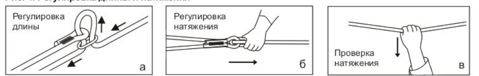
Рис. 4. Регулировка длины и натяжения
