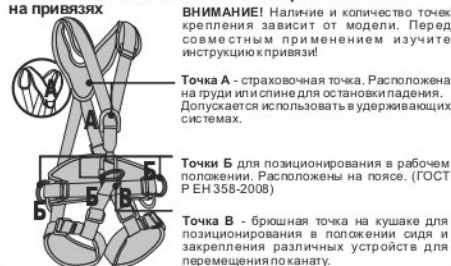
Рис. 5. Способы крепления к анкерным устройствам
