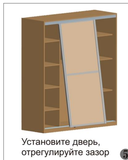
Установите дверь, отрегулируйте зазор 5
