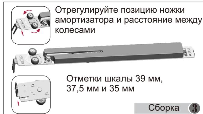
Отрегулируйте позицию ножи амортизатора и расстояние между колесами
