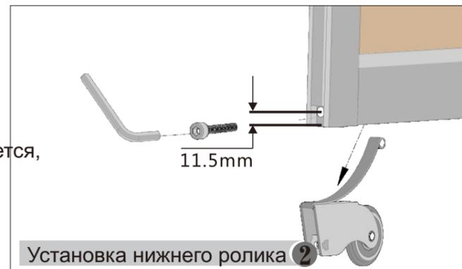
Установка нижнего ролика 2
