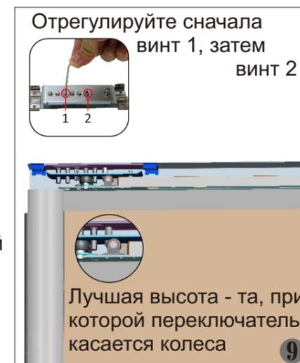
Отрегулируйте сначала винт 1, затем винт 2
