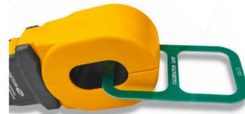
После включения и автоматической юстировки прибор устанавливается в режим измерения сопротивления, на дисплее отображается символ
