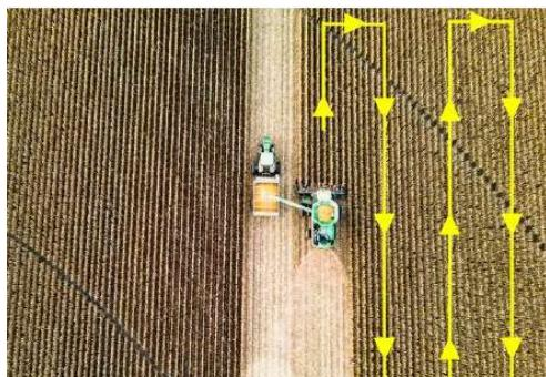
Selecione "S-Width" (S-Largura) no menu e, em seguida, prima **ENTER** (2) para aceder à interface de medição. Introduza a largura do veículo, prima **SAVE** (6) para confirmar os dados e, em seguida, prima **ENTER** (2) para calcular o caminho da operação. Durante o processo de medição, o dispositivo tem de ser colocado no centro da cabina do veículo.
