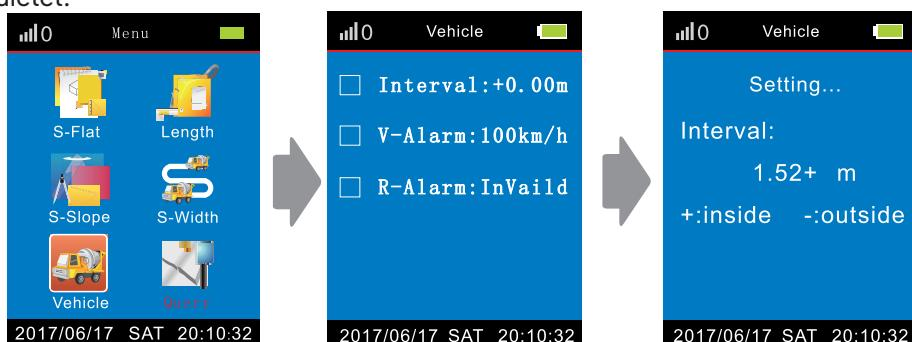
**Intervallum**      "-": a jármű szélessége nélkül; "+": a jármű szélességével.
