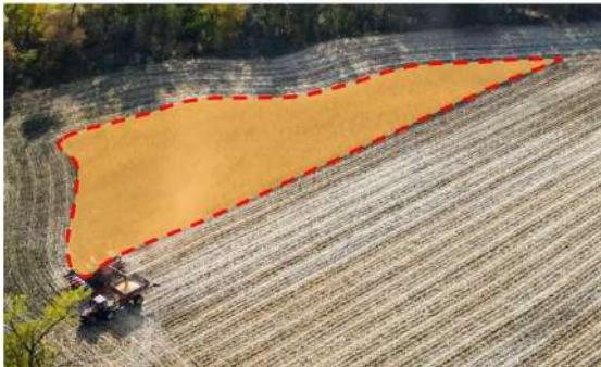
Wählen Sie im Menü "Vehicle" (Fahrzeug). Wählen Sie die Einstellungen und drücken Sie dann **ENTER** (2), um die Messung zu starten. Fahren Sie um die Grenzlinie des Grundstücks und die Fläche wird dabei automatisch berechnet.
