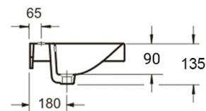
**1** Произведите разметку согласно посадочного размера раковины на столешнице.
