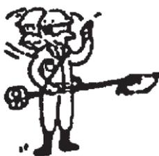
8. Не прикасайтесь к глушителю, свече зажигания или другим металлическим частям двигателя во время его работы или сразу после его остановки.
