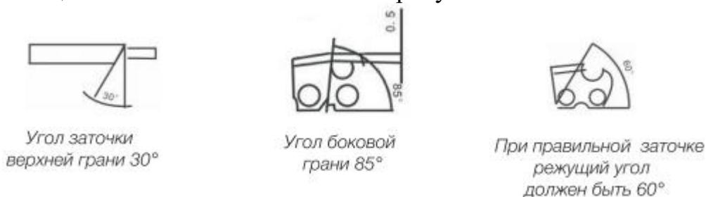
Затачивание делают «от себя», параллельно отметке — риску, которая есть на всех зубьях. Косая риска — это указатель угла заточки. Усилия и число движений должны быть равномерными на каждом зубце.
