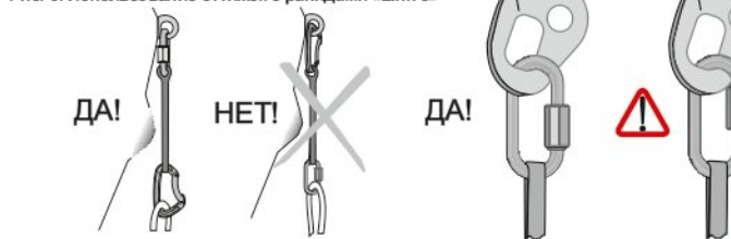
Рис. 6. Использование оттяжек с рапидами «Link 8»
