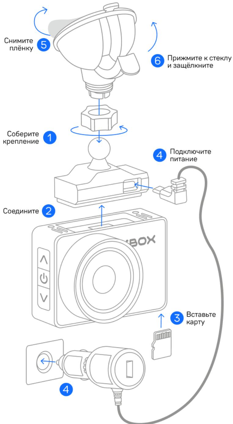
Для установки устройства на лобовое стекло автомобиля выберите удобный тип крепления: на присоске или двухстороннем скотче.
