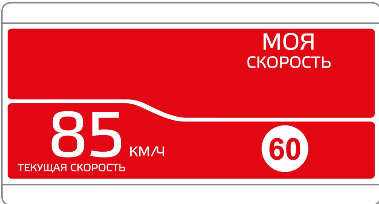
Вы можете настроить расстояние до камеры, на котором устройство потребует снизить скорость. Для этого перейдите в **Настройки радар-детектора или GPS-информатора, Дополнительные настройки, Снижайте скорость.**
