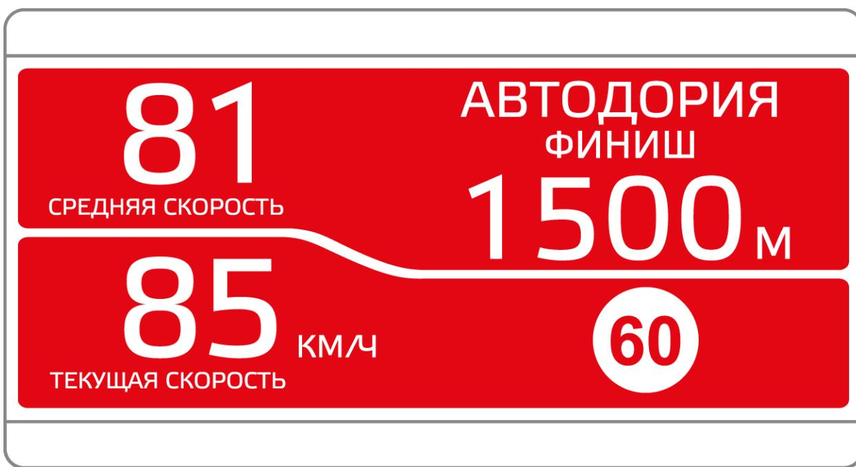
Если скорость автомобиля превышает разрешённую (перед такими камерами полиции, как Кордон, Одиссей, Робот, Кречет, Mesta, Поток). При этом учитывается допустимое превышение скорости, установленное в разделе **Дополнительные настройки**.
