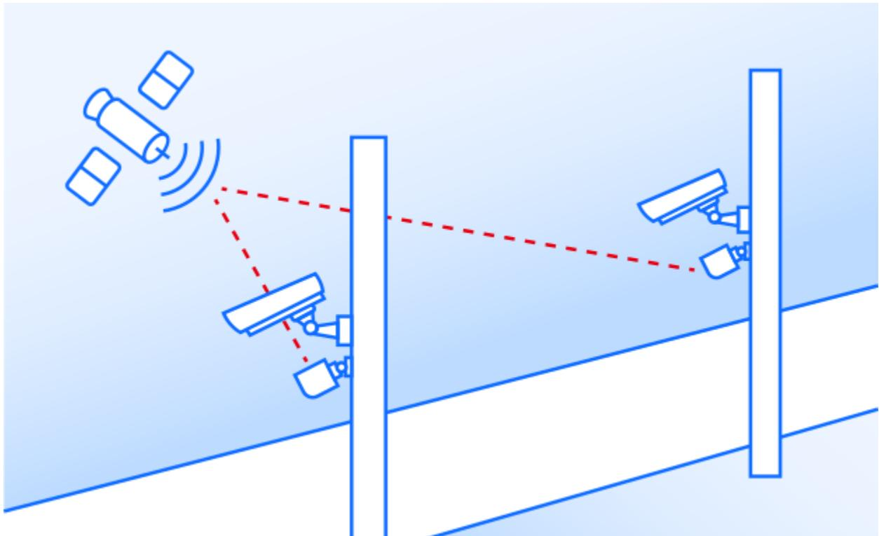
Автоураган/Автодория позволяет осуществлять непрерывный контроль за характером движения транспортного средства, задействуя камеры системы в нескольких зонах контроля одновременно. Например, три камеры могут образовать две зоны непрерывного контроля, четыре камеры — три зоны контроля и т. д.
